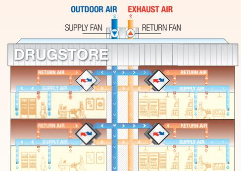
건물의 공기질은 내부 쾌적함을 위한 주요 요소들 중 하나입니다. 공기는 쾌적한 상태를 유지하기 위해 지속적으로 교체되어야 합니다. 이 공정은 판형 열교환기를 설치하여 회수되는 에너지를 버립니다. 예를들면, 면적이 1235m<sup>2</sup>이고 평균 밀도기310명인약국의공기를 바꾸려면 10,000m<sup>3</sup>/h의 신선한공기가 필요 합니다. 이에는 우리의 공기대공기판형열교환기가 적용된 시스템을 보여줍니다.
